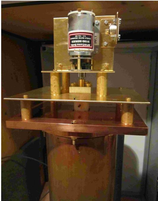
Abbildung 5: Die Konstruktion zum Einbau der Magnete in den Resonatorraum
