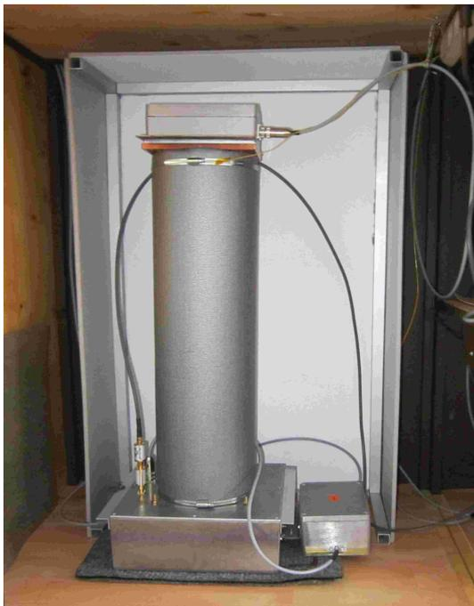
Abbildung 4: Der Oszillator mit Koaxialresonator, LED-Bestrahlung und Stromversorgung
