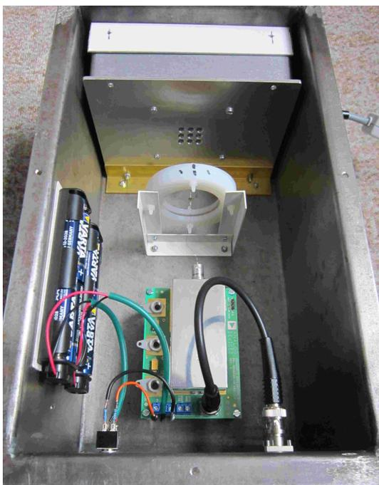
Abbildung 6: Die Bestrahlung der Spiegelsonde in Verbindung mit dem Elektrometer
